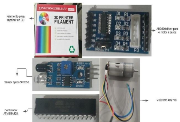
Fig. 10. Filamento para impresora 3D, Driver ARD300, Sensor óptico SR0058, Controlador ATMEGA328 y Motor DC AR2770.
