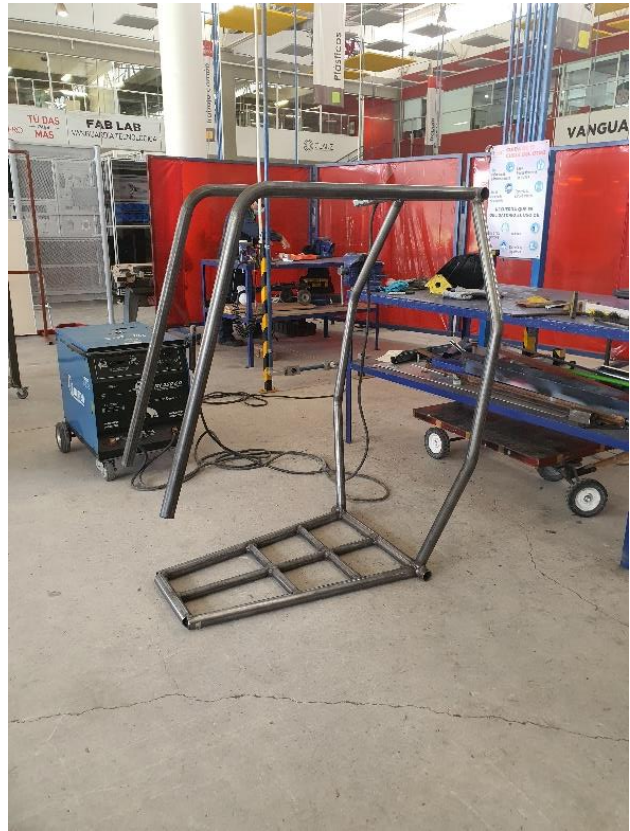
Fig. 12. Parte superior de la caja antivuelco completada.
