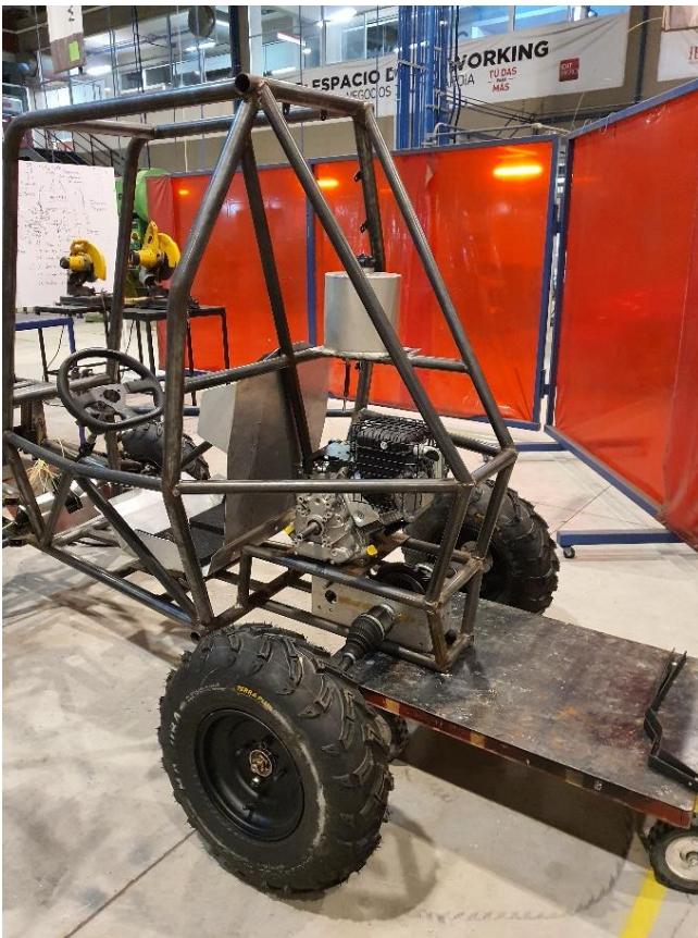
Fig. 22. Tanque de gasolina, motor y caja de transmisión en sus respectivos lugares de montaje.
