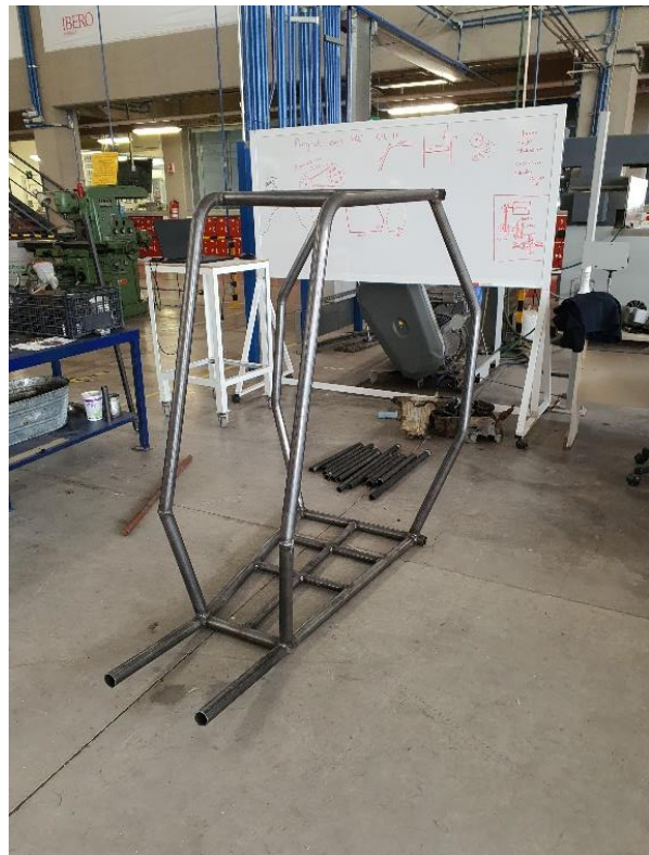
Fig. 13. Caja antivuelco completada.
