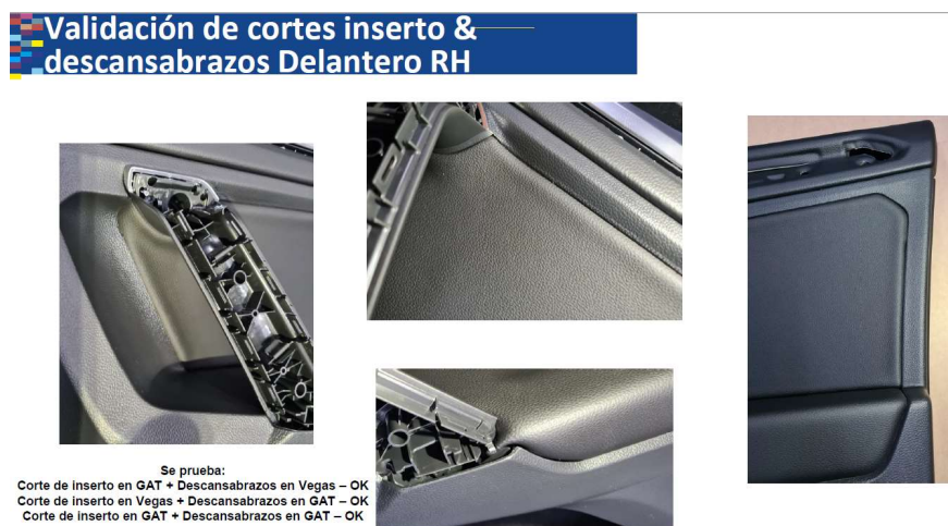
Figura 21 Prueba de ensamble con combinación de formatos de Industrias Vegas y Grupo Antolín Tlaxcala
