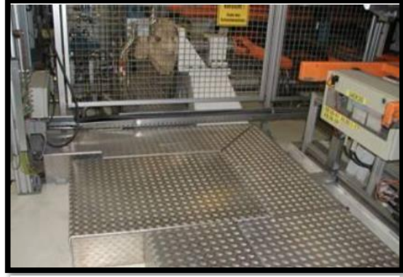
Ilustración 42, condición final, una vez implementada la mejora, la cual impide el daño prematuro y el acumulación de polvo y basura. Fuente, elaboración propia del alumno.
