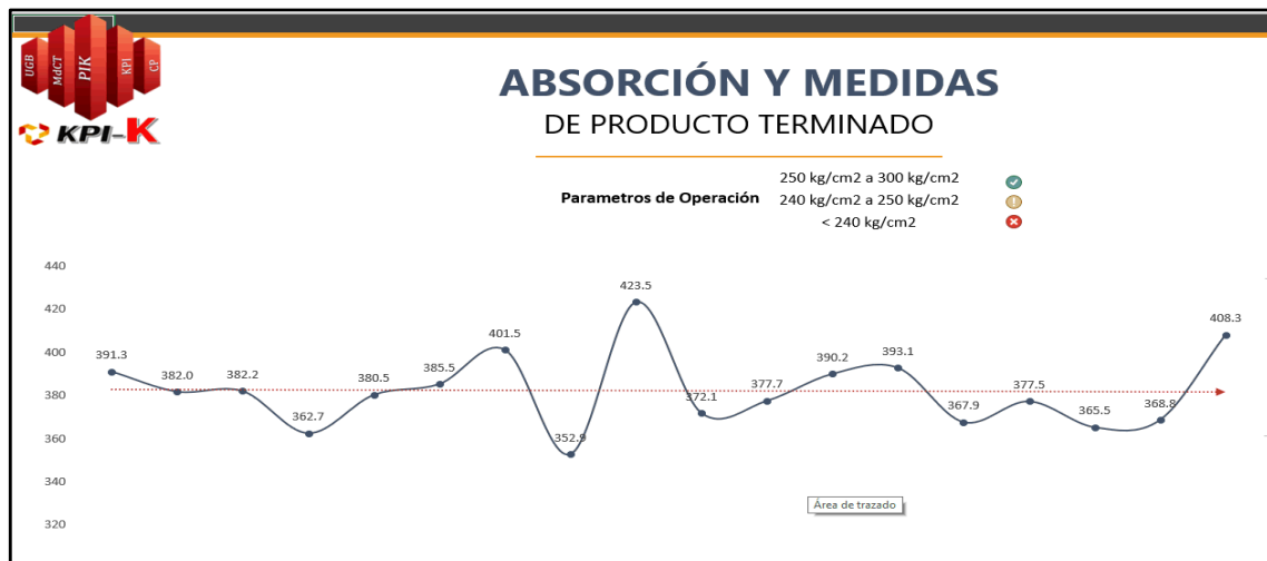
Figura 39 - Modulo de rotura en \text{kg/cm}^2 , formato 20x90cm. Fuente: Elaboración propia.
