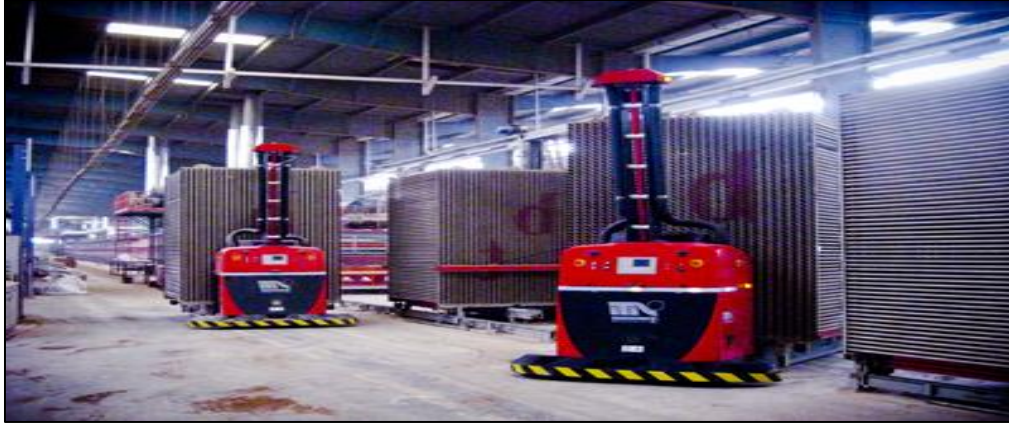
Figura 48 - Transporte de contenedores mediante LGV's. Fuente (Lamosa 2016)
