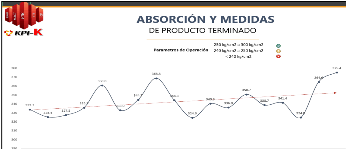
Figura 40 - Modulo de rotura en kg/cm 2 , formato 18x55cm. Fuente: Elaboración propia.
