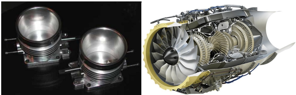
Figura 12. Aplicación típica de un acero endurecible por precipitación: cuerpo de aceleración de autos deportivos [29], alabes para motores tipo turbina jet [30]
