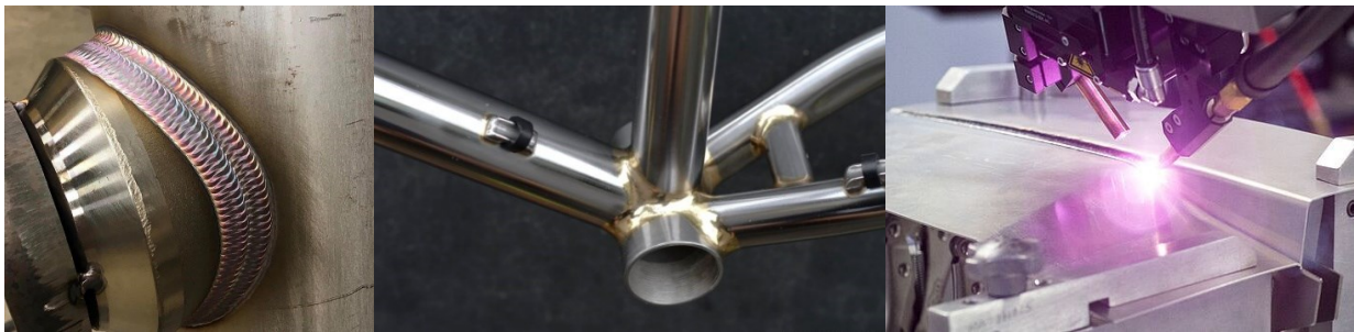
Figura 20. Procesos de soldadura: soldadura eléctrica GTAW y zona afectada por el calor [48], soldadura autógena (brazing) [49], soldadura por rayo láser [50]
