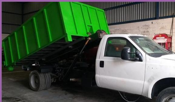
Figura 46: Maquinaria MV. (2020). *Camioneta con sistema de Roll-Off*. Recuperado de <https://www.facebook.com/452084771534925/posts/camioneta-con-sistema-de-roll-off-con-su-contenedor-disponible-en-maquinaria-mvt/3510582395685132/>
