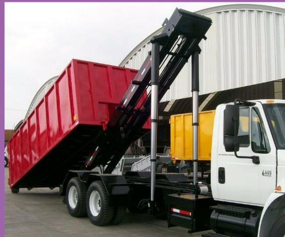
Figura 47: Carrocerías Repsa. (2020). *Camioneta con Sistema Hidráulico Roll Off*. Recuperado de <http://carroceriasrepsa.com/productos/roll-off-sistema-hidraulico.html>
