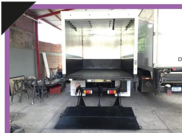
Figura 48: Mercado Libre. (s.f.). *Rampa Hidráulica Maxon Te-25 Especial Para Tarimas*. Recuperado de <https://articulo.mercadolibre.com.mx/MLM-564765136-rampa-hidraulica-maxon-te-25-especial-para-tarimas/>
