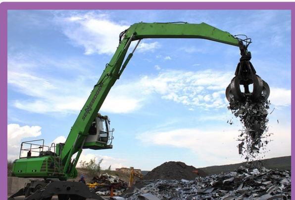
Figura 23: Demetal Reciclaje Industrial. (2021). *Grúa Sennebogen poligrapa 830 M*. Recuperado de: <https://demetal.com.mx/infraestructura/>
