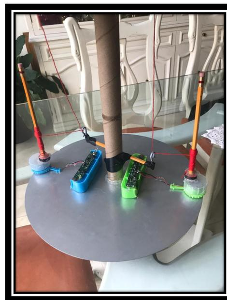
El mecanismo está conformado por dos motores de ventilador, plástico, tubos de cartón y rodamientos para que la placa base pueda girar y desenrollar el hilo.
