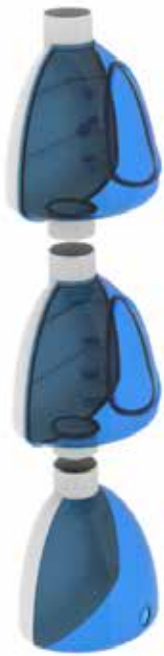
Imagen de elaboración propia 14. Filtro completo en posición vertical, vista frontal, incluidos los elementos internos.
