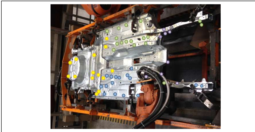
Figura 27. Colocación de pernos en plataforma.
