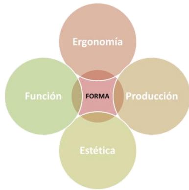
ESQUEMA 1 Factores para el desarrollo de proyectos de diseño industrial utilizados en el CIDI UNAM
