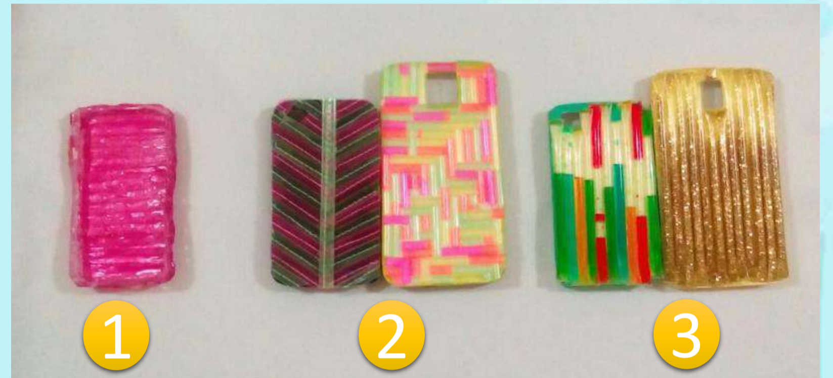
Ilustración 3 Funda para Celular 1)Planchado, 2)Pegado y 3)Llenado
