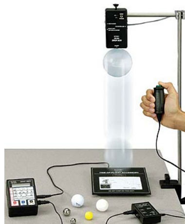
Fig. 4. Sistema para estudio del movimiento de caída libre de Pasco Inst. [2].
