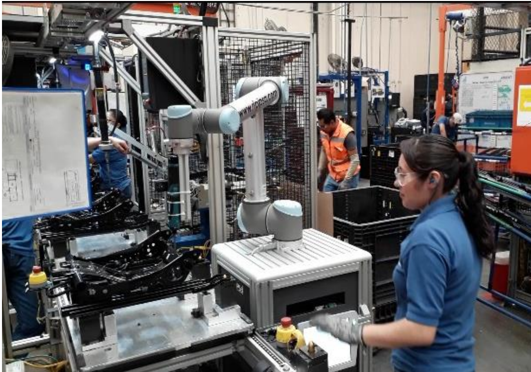
Imagen 3.- Implementación de Cobot en línea de fabricación Fuente: Empresa metalmecánica de fabricación de autopartes
