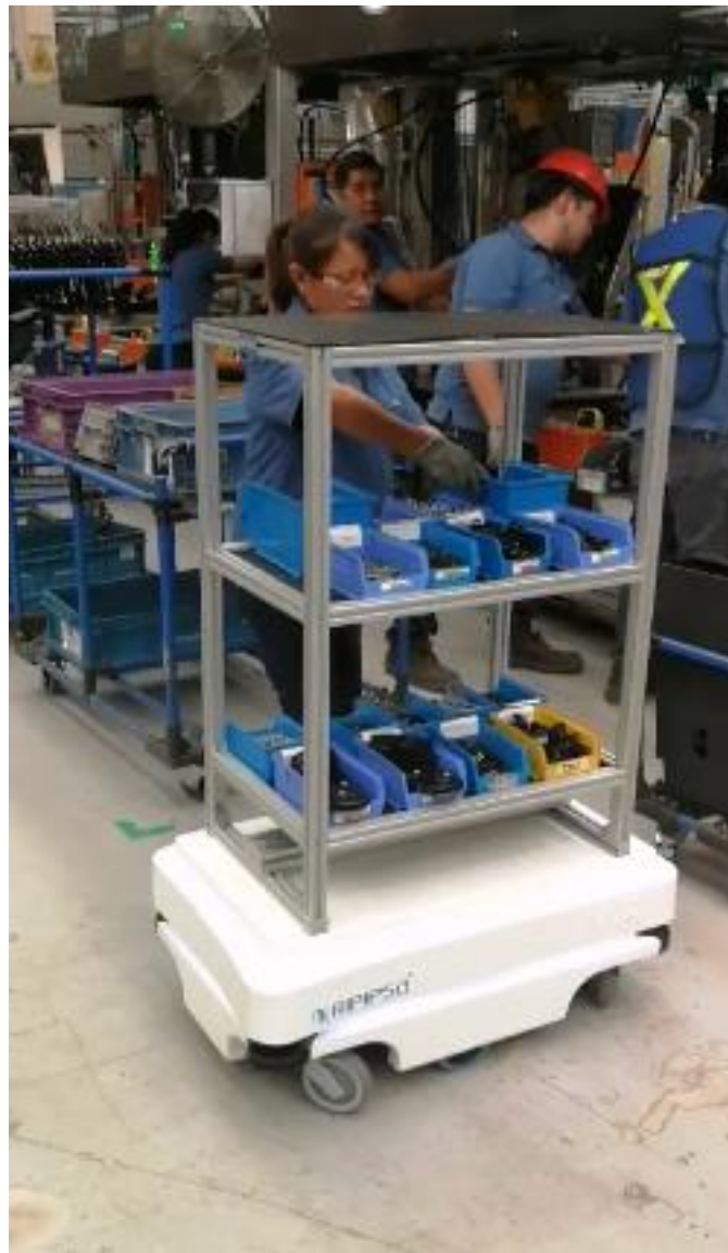
Imagen 4.- Surtimiento de materiales por medio de AMR Fuente: Empresa metalmecánica de fabricación de autopartes
