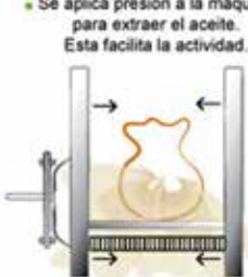
• Una vez envuelta la masa en la tela se coloca entre las placas de la prensa.
