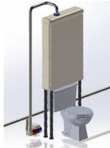
Fig.5 Visualización del tanque de almacenamiento, inodoro y bomba de agua.
