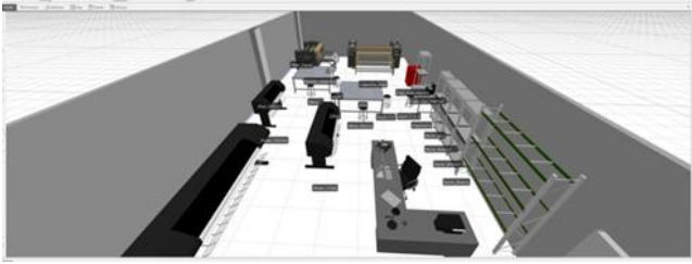
Fig. 12. Vista vertical 3D de la propuesta del layout para la nueva área de artes gráficas.
