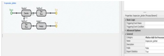
Fig. 9. Proceso de la simulación del proceso de sublimado en el software SIMIO.
