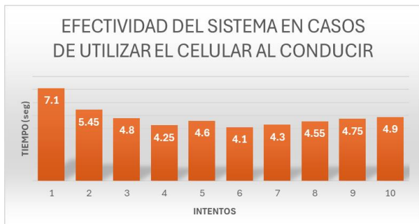
Fig. 11. Resultados de reacción del conductor con base en la sujeción del volante tras el uso de un dispositivo móvil
