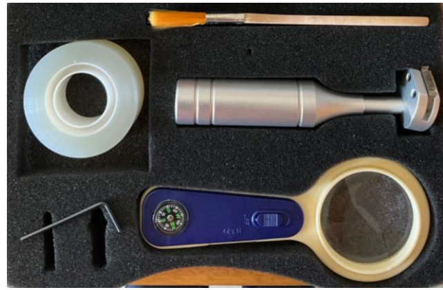
Fig. 8. Kit de prueba de adherencia de trama cruzada, modelo PCNADH.
