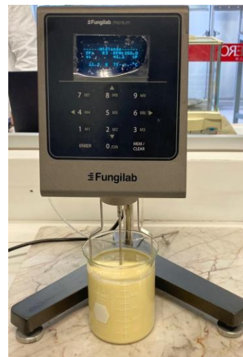
Fig. 3. Determinación de viscosidad con viscosímetro.
