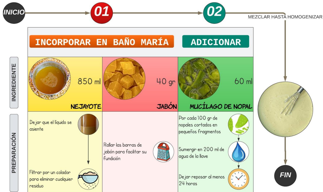
Fig. 1. Formulación y elaboración de impermeabilizante.
