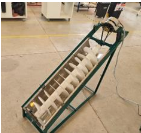
Fig. 9. Ensamble del generador
