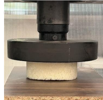
Fig. 11. Muestra cilíndrica prueba de compresión espuma Ibero en la máquina universal. Fuente: elaboración propia.
