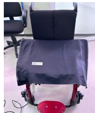
Fig. 8. Sensor de alta presión (Bodi Trak Pro). Fuente elaboración propia.
