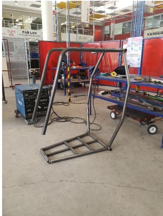
Fig. 12. Parte superior de la caja antivuelco completada.
