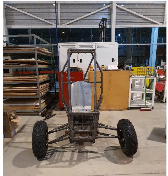
Fig. 17. Asiento y ruedas delanteras posicionadas a manera de prueba.
