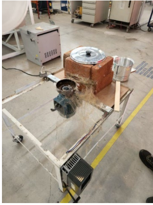
Fig. 8. Primera fibra de PET producida
