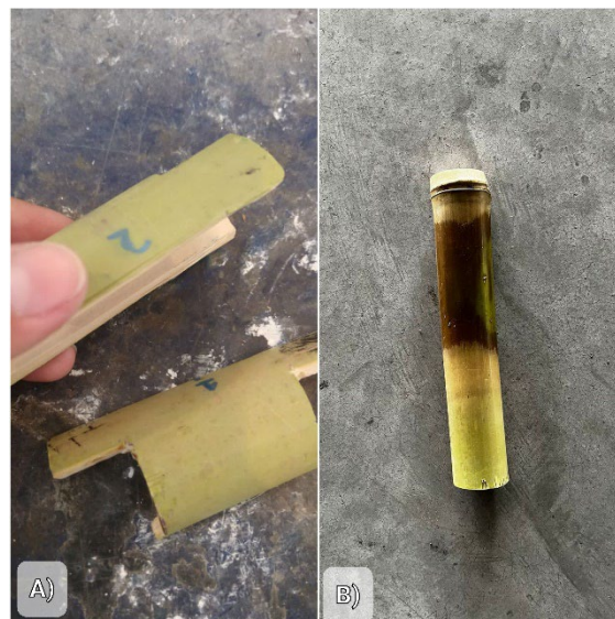
Fig. 7. A) Ruptura a lo largo del eje longitudinal de la pieza central con corte a dos dientes, B) Cambio de color del material debido a su descomposición por causas naturales. Elaboración Propia.
