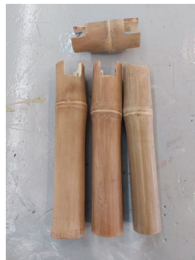
Fig. 5. Corte a dos dientes y en boca de pescado de las piezas de la conexión encajada en T. Elaboración Propia.
