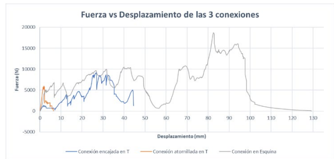
Fig. 22. Gráfica de Fuerza vs Desplazamiento de las 3 propuestas de conexiones obtenida de la máquina universal de esfuerzos.
