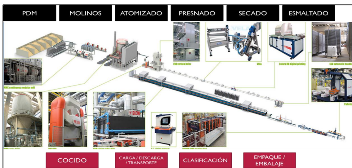
Figura 6 - Proceso de producción de revestimiento cerámico. Fuente: Elaboración propia
