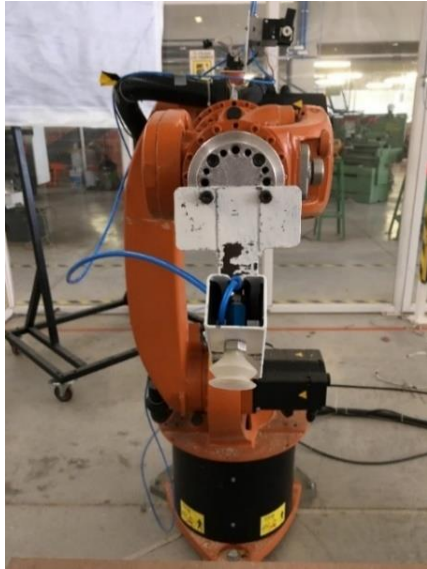
Figura 6.6: Herramienta tipo ventosa
