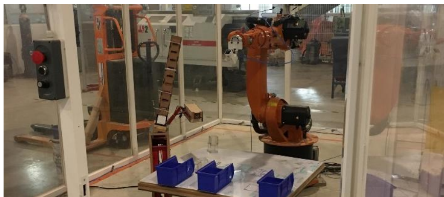
Figura 6.9: Robot KUKA KR16-2 digitalizado
