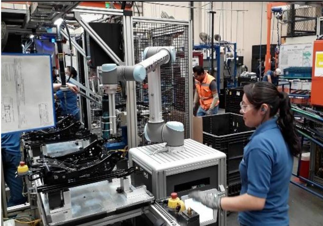
Imagen 3.- Implementación de Cobot en línea de fabricación
