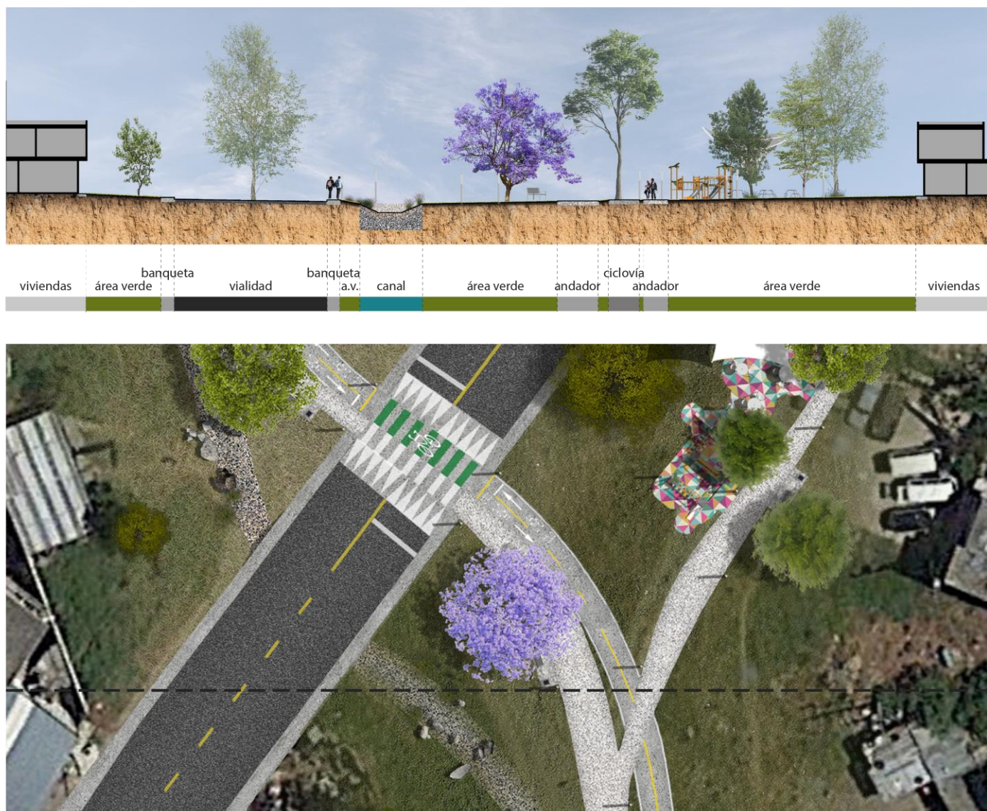
Ilustración 34. Detalle de la sección 1 vista en planta y en alzado. Elaboración propia con base en imágenes satelitales obtenidas de Google Earth.
