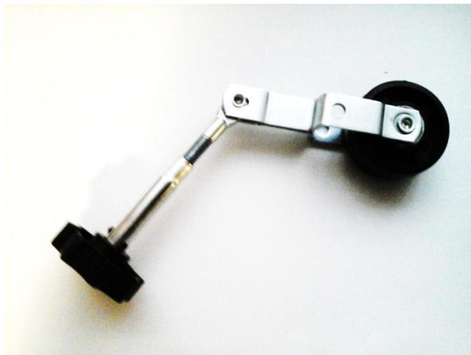
Figura 35 Tensor de bicicleta (Fuente: Lúa, 2015)
