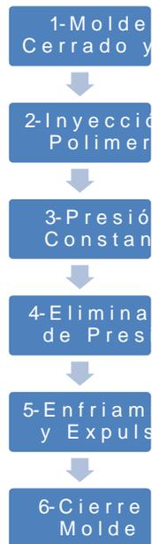
1. Molde cerrado y vacío. La unidad de inyección carga material y se llena de polímero fundido.
